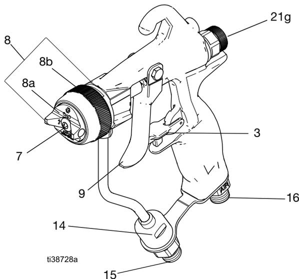
Рис. 2: PerformAA 15 без поворотного коннектора
