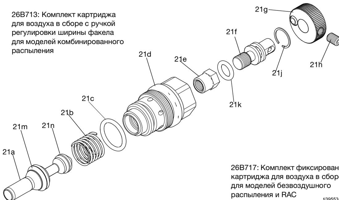
26В717: Комплект фиксированного картриджа для воздуха в сборе для моделей безвоздушного распыления и RAC
