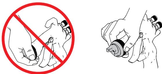
4. Вставьте сопло (7) в воздушную головку (8a) таким образом, чтобы фиксирующий язычок сопла был расположен в прорези воздушной головки. См. Рис. 7.
