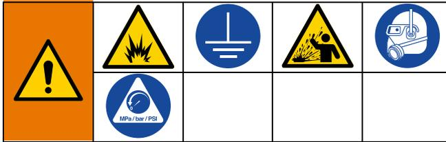
Во избежание пожара и взрыва всегда заземляйте оборудование и емкость для отходов. Во избежание статического искрения и получения травм в результате разбрызгивания материала всегда выполняйте промывку при минимально возможном уровне давления.
