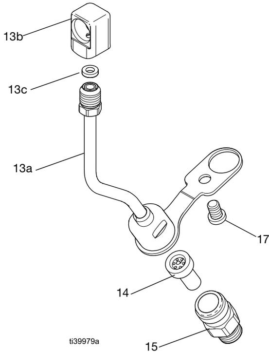
Рис. 57: Трубка для материала в сборе: модель 26B711
