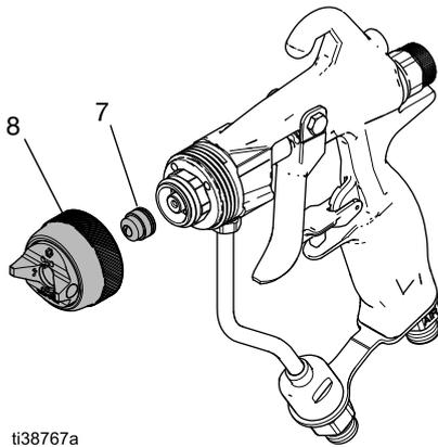
**Рис. 26: Извлечение воздушной головки и сопла**
