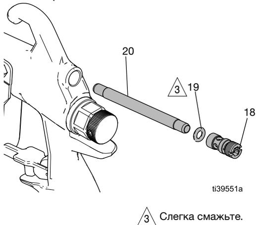
Рис. 49: Направляющая клапана регулировки ширины факела в сборе
