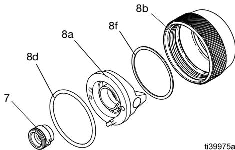
Рис. 46: Детали воздушной головки PerformAA 15 и сопло
