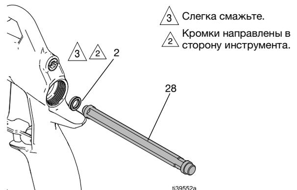
Рис. 47: Установка U-образного уплотнения
