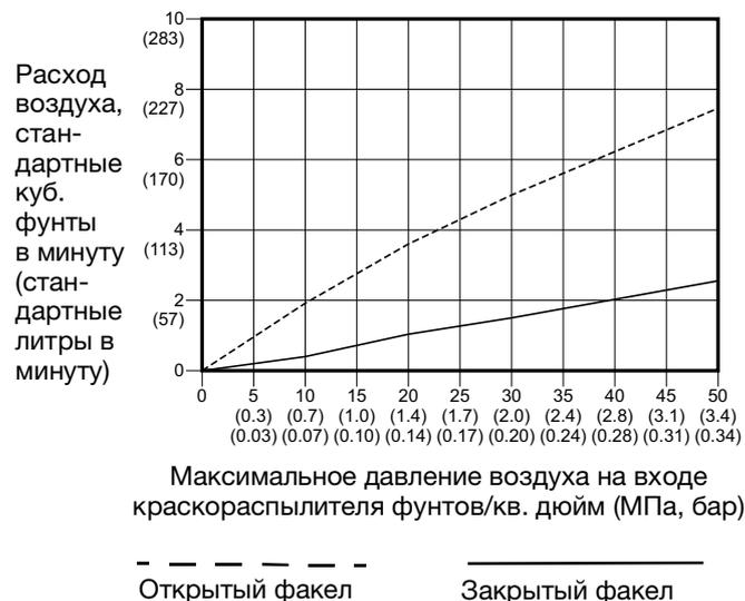
**Воздушные головки для низковязких материалов (LV) и материалов на водной основе (WB)**
