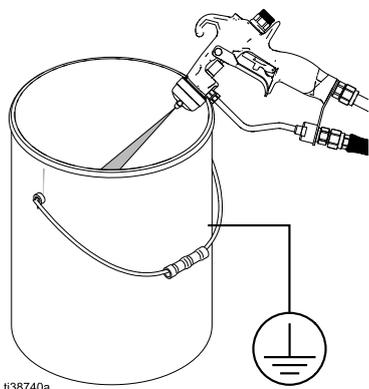
**Рис. 11: Сбросьте давление в краскораспылителе.**
