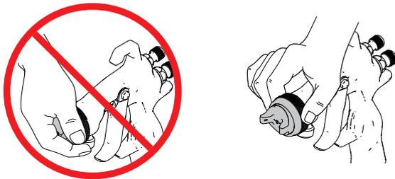
4. Installez la buse de pulvérisation (7) dans le chapeau d'air (8a) avec la languette de localisation de la buse positionnée dans la rainure du chapeau d'air. Voir FIG. 7.
