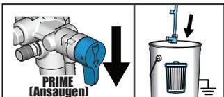
**2** Entlüftungs-/Spritzventil auf PRIME drehen. Ablassrohr in einen Abfallbehälter geben. Den Druckreglerknopf auf die START-Position drehen.
