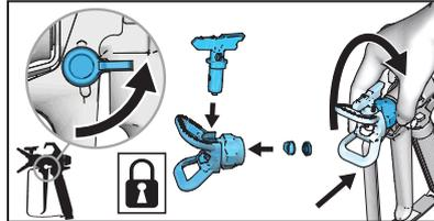
**2** Abzugssperre verriegeln. Sicherstellen, dass Spritzdüse ordnungsgemäß in den Spritzdüsenenschutz eingesetzt ist und die Spritzdüsenchutzgruppe festgezogen ist.
