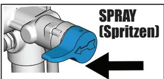
**6** Entlüftungs-/Spritzventil zur Lagerung auf die SPRAY-Position drehen. Netzschalter auf OFF stellen und Netzstecker des Spritzgeräts aus der Steckdose ziehen.
