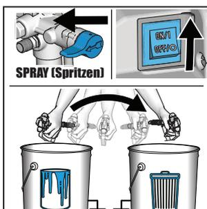
**5** Zum Halten von Farbe im Schlauch, Abzugssperre entriegeln und Spritzpistole in einen Farbbehälter auslösen, Entlüftungs-/Spritzventil auf SPRAY drehen und Netzschalter auf ON stellen. Falls Wasser aus der Pistole austritt, Pistole auslösen und in einen Abfallbehälter zielen. Solange spülen, bis das Wasser klar wird.
