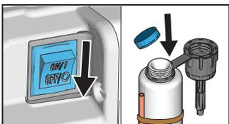
**4** Beim Spülen von Spritzgerät, Netzschalter auf OFF STELLEN. Zur Lagerung Kindersicherungsverschluss wieder aufsetzen und festdrehen.
