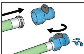
**3** Power Flush™-Ventil (im Lieferumfang des Spritzgeräts enthalten) auf einen Gartenschlauch schrauben. Wasser einschalten. Power Flush-Ventil öffnen. Farbe aus Saugrohr, Ablassrohren, Einlasssieb, Spritzdüse und Spritzdüsenchutz spülen. Power Flush-Ventil schließen.
