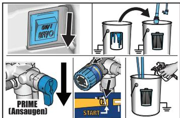
**1** Netzschalter auf OFF stellen. Saug- und Ablassrohr in Abfalleimer geben. Entlüftungs-/Spritzventil auf PRIME drehen. Den Druckreglerknopf auf die START-Position drehen. Spritzpistole in einen Abfallbehälter auslösen.
