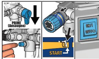
**3** Entlüftungs-/Spritzventil auf die PRIME-Position drehen. PushPrime-Schalter™ zweimal drücken, um Einlassventilkugel zu lösen. Den Druckreglerknopf auf die START-Position drehen. Netzschalter auf ON stellen.
