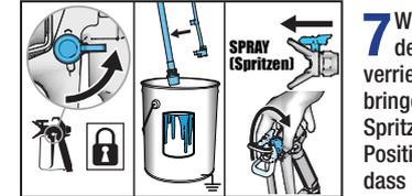
**7** Wenn Farbe aus der Pistole kommt, den Abzug loslassen. Abzugssperre verriegeln. Ablassrohr in Farbeimer bringen und an Saugrohr befestigen. Spritzdüse zurück in die SPRAY-Position drehen und sicherstellen, dass der Spritzdüsenchutz fest ist.
