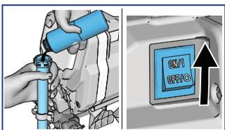
**3** Saugrohr über das Spritzgerät halten, dabei ungefähr 60 ml Pump Armor in das Saugrohr geben und Netzschalter auf ON STELLEN.
