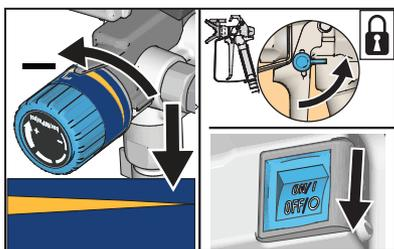
**6** Druckreglerknopf auf die niedrigste Stufe drehen und Abzug loslassen. Abzugssperre verriegeln. Entlüftungs-/Spritzventil auf PRIME drehen und Netzschalter auf OFF stellen.
