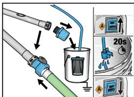
**4** Einlasssieb abschrauben und in einen Abfallbehälter geben. Power Flush-Ventil auf Saugrohr montieren. Power Flush-Ventil öffnen. Netzschalter auf ON stellen und für 20 Sekunden Wasser durch das Ablassrohr laufen lassen. Netzschalter auf OFF STELLEN.
