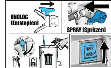
**6** Spritzdüse in die UNCLOG-Position drehen. Abzugssperre entriegeln. Mit Spritzpistole auf den Abfallbehälter zielen, Abzug ziehen und halten. Das Entlüftungs-/Spritzventil in die SPRAY-Position drehen und Netzschalter auf ON stellen.
