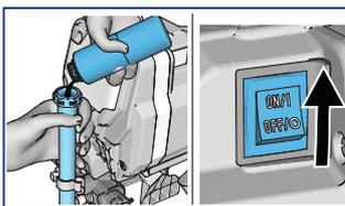
**3** Tout en maintenant le tuyau d'aspiration au-dessus du pulvérisateur, versez environ 60 ml (2 onces) de Pump Armor dans le tuyau d'aspiration et mettez l'interrupteur principal en position ON (MARCHÉ).
