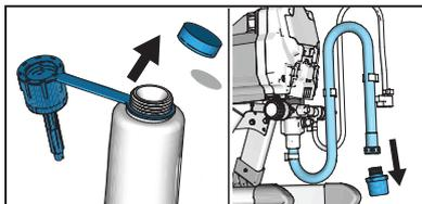
**1** Retirez le capuchon de bouteille de Pump Armor™ et le joint de feuille. Si nécessaire, dévissez le tamis d'entrée du tuyau d'aspiration.
