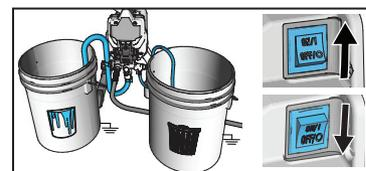
**5** Plongez le tuyau d'aspiration dans la peinture. Mettez l'interrupteur principal en position ON (MARCHÉ) et attendez que la peinture sorte du tuyau de vidange. Mettez l'interrupteur principal en position OFF (ARRÊT).
