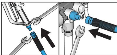
**1** Si nécessaire, branchez le tuyau sur le pistolet. Retirez le capuchon rouge, puis branchez le tuyau sur le pulvérisateur. Serrez correctement.
