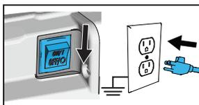
**1** Mettez l'interrupteur principal en position OFF et branchez le pulvérisateur sur la sortie à la masse.
