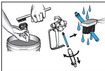
**7** Nettoyez la buse de pulvérisation, la protection de buse de pulvérisation et le tamis d'entrée avec une brosse. Retirez le filtre de pistolet et nettoyez-le. Remontez le filtre de pistolet, la buse de pulvérisation et la protection de buse de pulvérisation.
