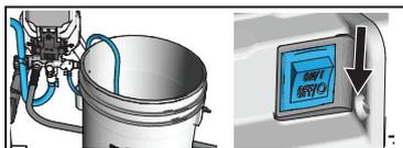
**4** Laissez le liquide s'écouler dans le tuyau d'aspiration et en dehors du tuyau de vidange pendant 30 à 60 secondes. Mettez l'interrupteur principal en position OFF (ARRÊT).
