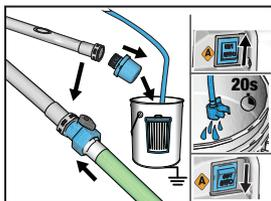
**4** Dévissez le tamis d'entrée et mettez-le dans le seau à déchets. Vissez la vanne de rinçage forcé sur le tuyau d'aspiration. Ouvrez la vanne de rinçage forcé. Mettez l'interrupteur principal en position ON (MARCHÉ) et laissez l'eau s'écouler dans le tuyau de vidange pendant 20 secondes. Mettez l'interrupteur principal sur OFF (ARRÊT).
