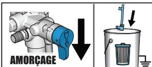
**2** Mettez la vanne d'amorçage/ de pulvérisation sur PRIME (AMORÇAGE). Mettez le tuyau de vidange dans le seau à déchets. Mettez le bouton de réglage de pression en position START (DÉMARRAGE).
