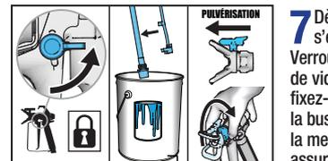
**7** Dès que la peinture commence à s'écouler du pistolet, relâchez la gâchette. Verrouillez la gâchette. Transférez le tuyau de vidange dans le seau de peinture et fixez-le au tuyau d'aspiration. Faites tourner la buse de pulvérisation vers l'arrière pour la mettre en position PULVÉRISATION et assurez-vous que la protection de buse de pulvérisation est bien serrée.
