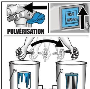
**5** Pour garder de la peinture dans le tuyau, désenclenchez le verrou de la gâchette et actionnez le pistolet dans un seau à déchets, mettez la vanne d'amorçage/pulvérisation en position PULVÉRISATION et mettez l'interrupteur principal en position ON (MARCHÉ). Lorsque l'eau commence à sortir du pistolet, maintenez la gâchette enfoncée et dirigez le pistolet vers l'intérieur du seau à déchets. Continuez à rincer jusqu'à ce que l'eau soit claire.
