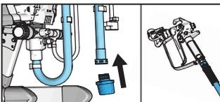
**5** Révissez le tamis d'entrée sur le tuyau d'aspiration. Assurez-vous que le pistolet pulvérisateur et le tuyau restent bien attachés au pulvérisateur.
