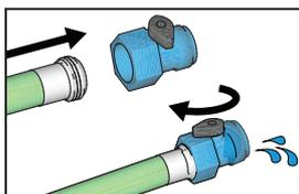
**3** Vissez la vanne de rinçage forcé Power Flush™ (y compris le pulvérisateur) sur un tuyau d'arrosage. Ouvrez la vanne de rinçage forcé. Rincez les tuyaux d'aspiration et de vidange, le tamis d'entrée, la buse de pulvérisation et la protection de buse d'aspiration pour éliminer la peinture. Fermez la vanne de rinçage forcé.
