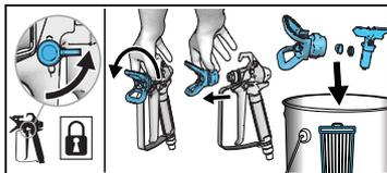
**2** Verrouillez la gâchette. Retirez l'ensemble de protection de buse de pulvérisation du pistolet et déposez-le dans le seau à déchets.
