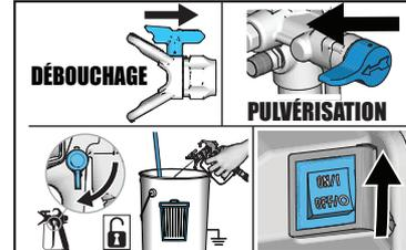
**6** Tournez la buse de pulvérisation en position DÉBOUCHAGE. Déverrouillez la gâchette. Orientez le pistolet dans le seau à déchets, tirez la gâchette et maintenez-la dans cette position. Mettez la vanne d'amorçage/de pulvérisation en position PULVÉRISATION et mettez l'interrupteur principal sur ON (MARCHÉ).
