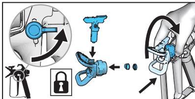
**2** Verrouillez la gâchette. Veillez à ce que la buse de pulvérisation soit correctement insérée dans la protection de buse de pulvérisation et que l'ensemble de protection de buse de pulvérisation soit correctement serré sur le pistolet.
