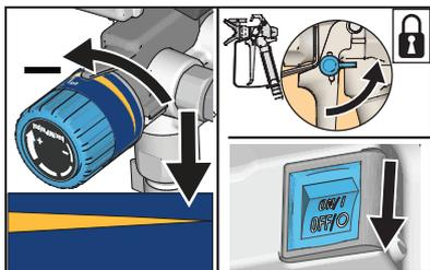
**6** Tournez le bouton de réglage de pression sur le réglage le plus bas et relâchez la gâchette. Verrouillez la gâchette. Mettez la vanne d'amorçage/ de pulvérisation sur AMORÇAGE et mettez l'interrupteur principal sur OFF (ARRÊT).
