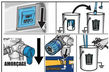
**1** Mettez l'interrupteur principal sur OFF (ARRÊT). Plongez le tuyau d'aspiration et le tuyau de vidange dans le seau à déchets. Mettez la vanne d'amorçage/ de pulvérisation sur PRIME (AMORÇAGE). Mettez le bouton de réglage de pression en position START (DÉMARRAGE). Actionnez le pistolet dans le seau à déchets.
