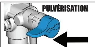
**6** Mettez la vanne de pulvérisation/ d'amorçage en position PULVÉRISATION pour le stockage. Mettez l'interrupteur principal en position OFF (ARRÊT) et débranchez le pulvérisateur de la prise.
