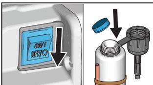
**4** Lorsque le Pump Armor s'écoule dans le pulvérisateur, mettez l'interrupteur principal en position OFF (ARRÊT). Remplacez et serrez le capuchon de sécurité enfant pour le stockage.
