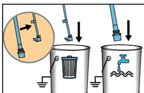
**2** Débranchez le tuyau de vidange (petit) du tuyau d'aspiration (gros). Mettez le tuyau de vidange dans le seau à déchets. Plongez le tuyau d'aspiration dans un seau rempli d'eau si vous pulvérisez un produit à base d'eau ou de white spirit si vous pulvérisez un produit à base d'huile.
