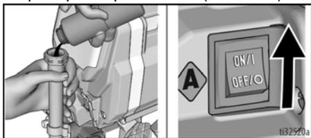
6. Lorsque le Pump Armor dans l'appareil est rincé et qu'il n'est plus présent dans le tuyau de vidange, mettez l'interrupteur principal en position **OFF** (ARRÊT). Remplacez et serrez le capuchon de sécurité enfant pour le stockage.
