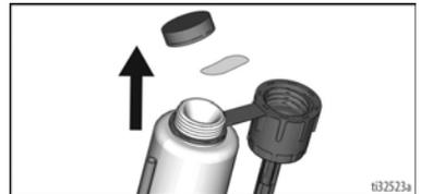
3. Si nécessaire, dévissez la crépine du tuyau d'aspiration. Mettez la vanne d'amorçage/de pulvérisation en position **AMORÇAGE**.
