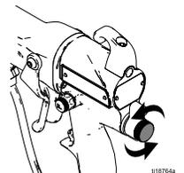
17. Abra completamente la válvula reductora del aire de atomización (G) en sentido horario.
