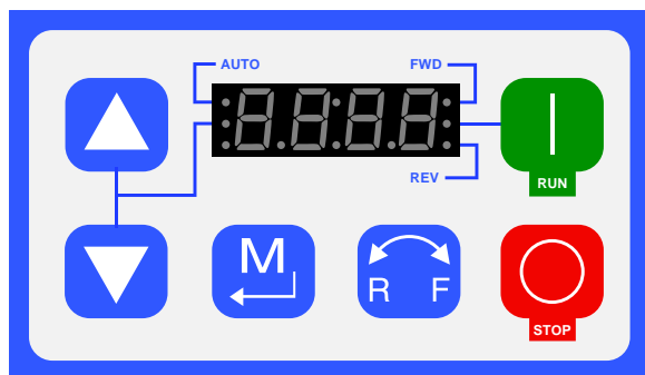
Figure 15 VFD コントロールパネル
