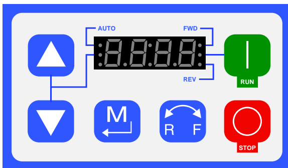
Figure 15 Panneau de commandes de VFD
