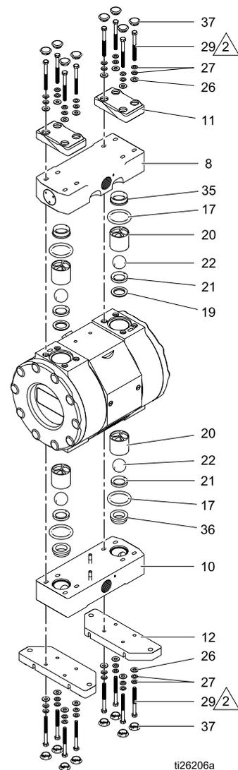
7. Die O-Ringdichtung (17) aus der Auslassseite jeder Materialabdeckung (6) abnehmen.
