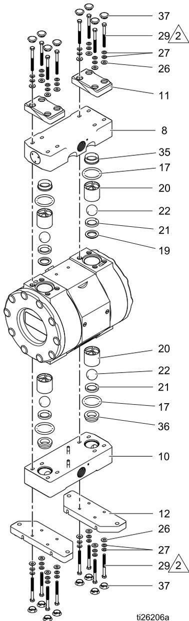
8. Den Auslassverteiler (8) auf der Baugruppe mit dem Auslassanschluss ausrichten, der in die richtige Richtung für Ihre Anwendung zeigt.
