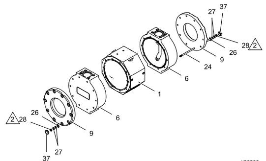
10. Zum Entfernen der Muttern (28) und Schrauben (24) zwei 10 mm-Steckschlüssel verwenden, um eine Seite zu halten, während die andere gedreht wird. Die Muttern (28) treten nur auf einer Seite heraus. Anschließend die Schrauben (24) abnehmen.
