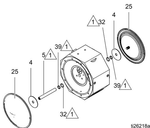
2. O-Ring-Dichtungen (32) und Dichtungen (39) der Gleitwelle prüfen. Diese bei Bedarf ersetzen.
