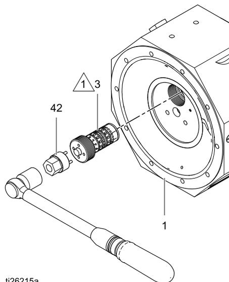
7. Jede Steuerventilbaugruppe (3) auf verschlissene oder schadhafte Teile prüfen. Jede Baugruppe nach Bedarf auswechseln.
