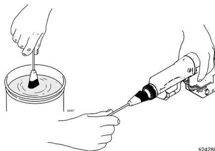
**Fig. 13. Limpieza de la parte delantera de la pistola**
