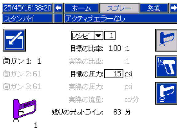
Figure 45 スプレー画面、壁面で混合による
