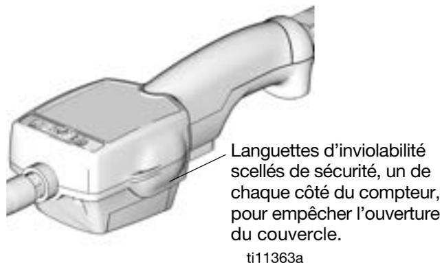
Languettes d'invulnérabilité scellés de sécurité, un de chaque côté du compteur, pour empêcher l'ouverture du couvercle.
