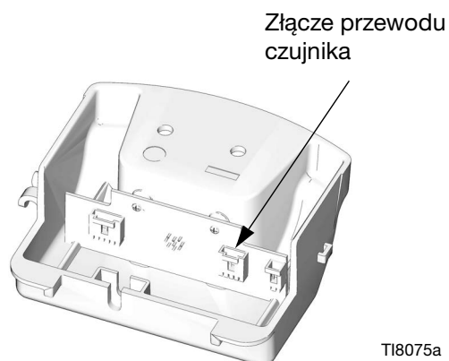
Rys. 15. Złącze przewodu czujnika
