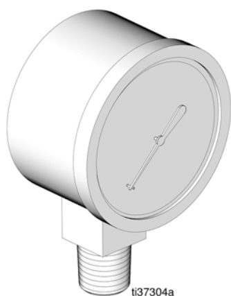
Provedení 1 (dolní vstupní otvor)
